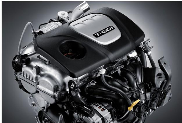
Un autre problème des moteurs T-GDI peut être le LSPI. Voir également la lettre d'information MPM OEM numéro 04-2019. LSPI signifie « low speed pre-ignition », (à bas régime et à forte charge, le mélange de carburant s'enflamme trop tôt), ce qui peut causer d'énormes dégâts au moteur (comme l'endommagement du piston). L'utilisation d'autres additifs dans le lubrifiant permet d'éviter le LSPI. Les tests LSPI sont donc inclus dans les dernières spécifications (OEM).
